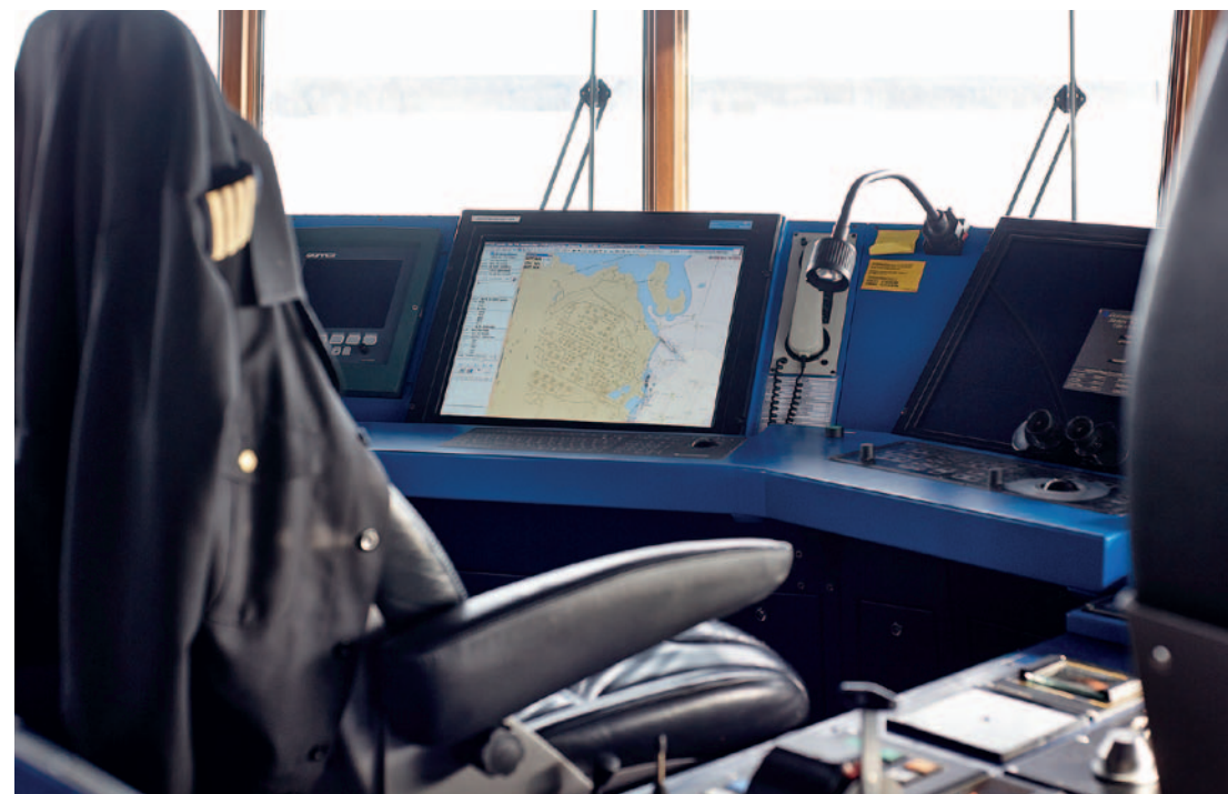
ENSI-palvelu perustuu sähköisten karttamateriaalien hyödyntämiseen. Merenkulussa ollaan parhaillaan siirtymässä perinteisistä paperikartoista sähköisiin karttoihin, joita käytetään ECDIS-laitteelta. Vasemman puoleisessa kuvassa ENSI-portaali tablettitietoneella ja oikean puoleisessa kuvassa ECDIS komentosillalla.
